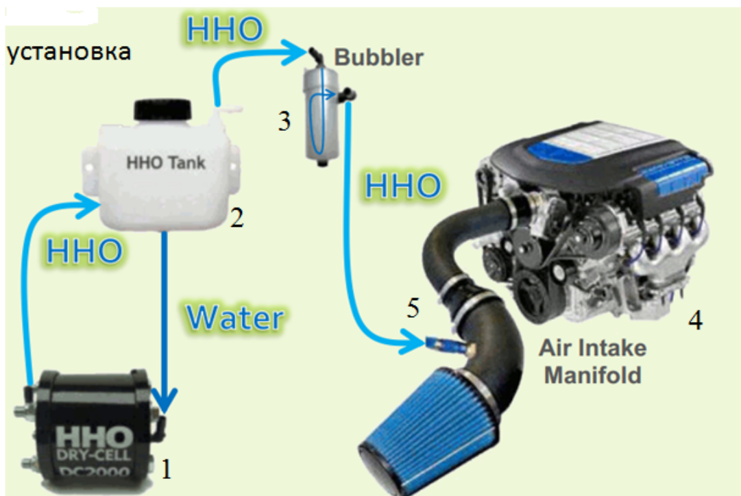
1- водородный генератор; 2-бочка воды; 3-осушитель; 4-двигатель; 5-впускная труба Рисунок 3.5 - Общая конфигурация
