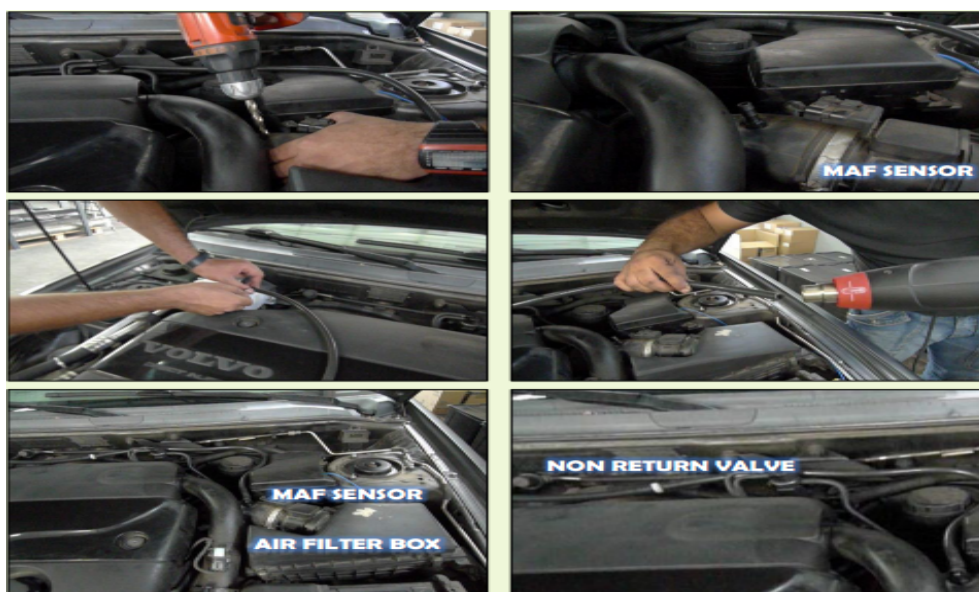
Рисунок 3.13 - Точка впрыска ННО
