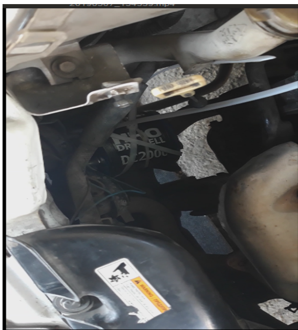
Рисунок 3.7 - Расположение сухого ячейки на машине
