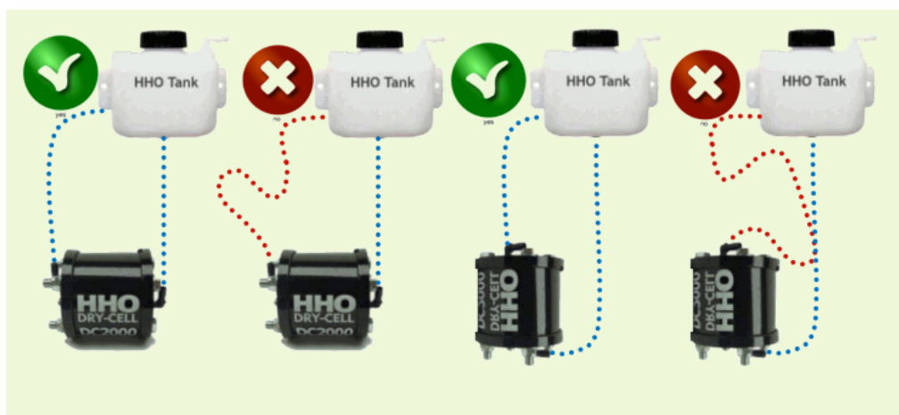
Рисунок 3.10 - Размещение воды и шлангов ННО
