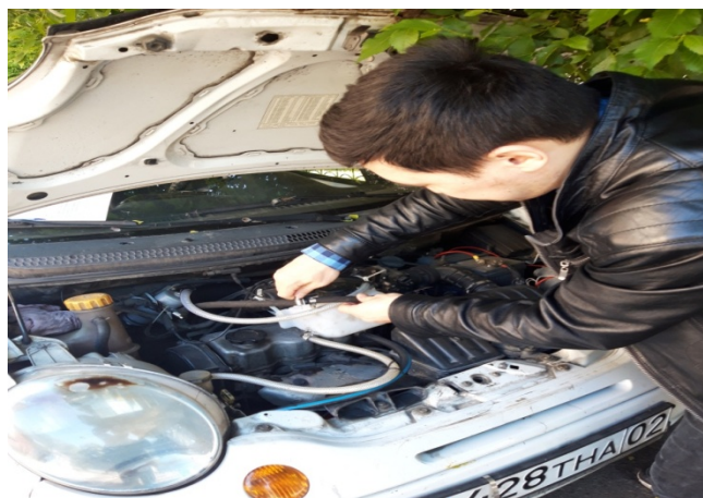
Рисунок 3.11 - Крепление шланга с помощью хомут
