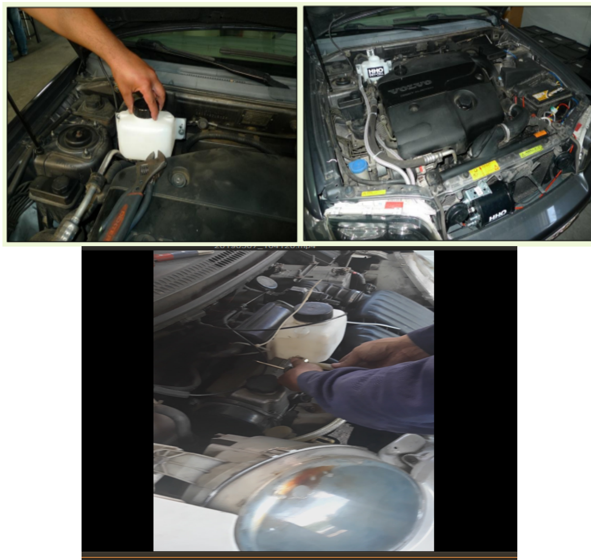
Рисунок 3.8 - Расположение резервуара для воды
